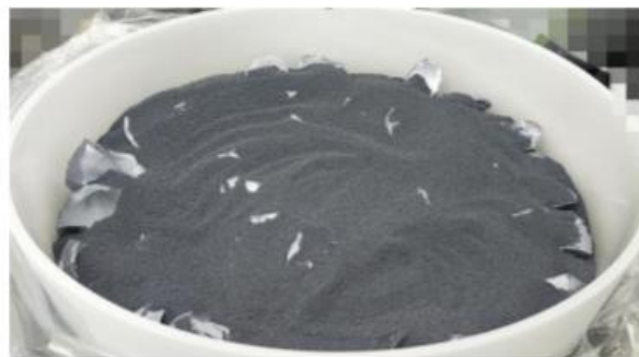
图 22: FBR 颗粒硅—填充性好、有效提升拉晶效率
