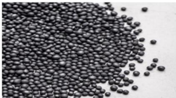
图 21: FBR 颗粒硅—流动性好、免破碎、满足复投需求
